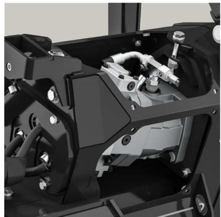
**パワフル** 107ccまたは170ccの可変容量モーターを搭載しており、68mmの強力なポリベルトが動力をローターに伝えます。ポリベルトはメンテナンス頻度が少なく、滑りにくい動力伝達方法です。
