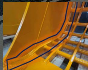
バケットを内側から、サイドインナーリブで支え全体の構造を強化する設計で耐久性が向上しています。
